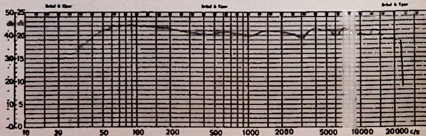
Frequentiekarakteristiek van de L810, gemeten met sinustonen.
