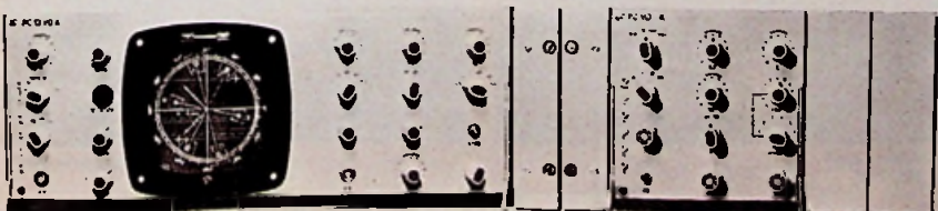
Fig. 25. PAL-vectorscoop van FERNSEH GmbH (PC13 VO en PC VD 43), tevens geschikt voor NTSC.
